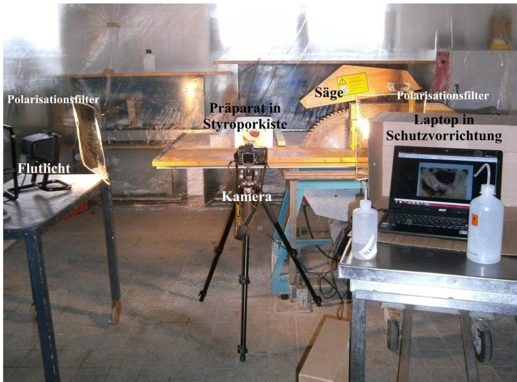
**Abbildung 14:** Säge- und Aufnahmevorrichtung
