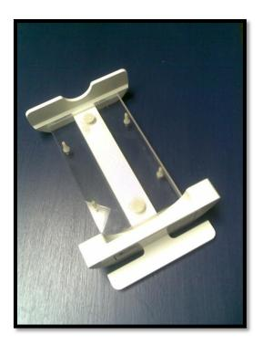
Abbildung 9: Schlitten zum Einbringen der Patella in die Small Extremity Coil
