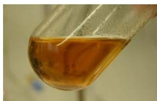
Die Aufarbeitung des *N*-Vinylharnstoffs **208** erwies sich ausnahmsweise als sehr einfach. Nach zwölf Stunden bei 4 °C fiel **208** als Feststoff im Einschlußkolben ("sealed tube") aus.
