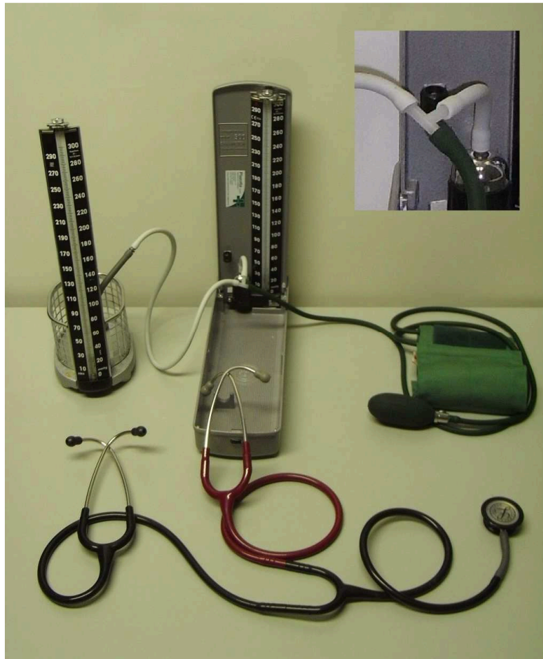
In der Bildmitte 2 hintereinandergeschaltete Quecksilber-Manometer. Der Bildausschnitt oben rechts zeigt ein zur Druckverteilung zwischen den Schläuchen integriertes T-Stück. Das Stethoskop im Vordergrund befindet sich im handelsüblichen Originalzustand.
