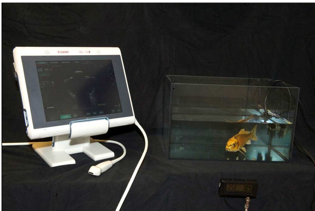
Abbildung 15: Versuchsaufbau zur sonographischen Augenuntersuchung, Koi unmittelbar nach dem Umsetzen ins Narkosebad, Aufnahme: R. Korbelt
