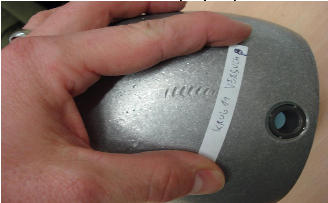
Abb. 9: Delle im Alu-Kern des Dummy-Kopfes Hybrid III
