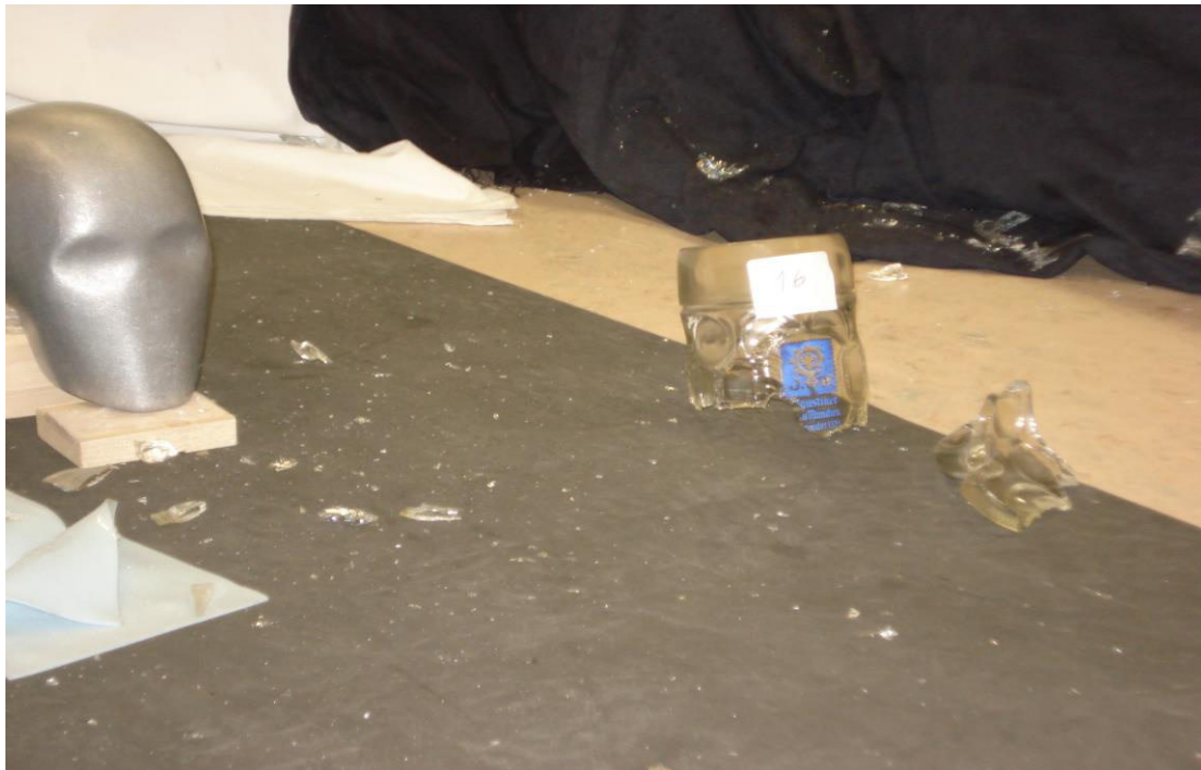
Abb. 7 Bruchmuster Versuchsreihe I
