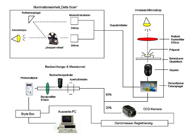
Abb. 2.4: Schematischer Aufbau von Kalziummessplatz und Durchmesserregistriersystem
