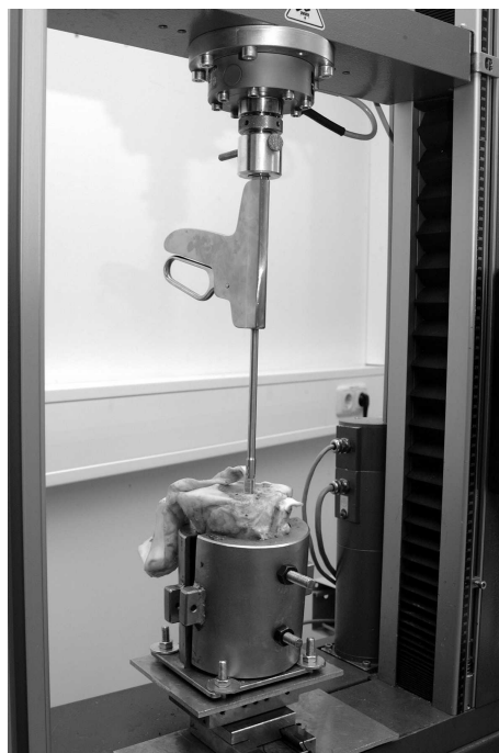
Abbildung 15: Versuchsaufbau beim Einpressen des Spreizkeils in den Spreizdübel
