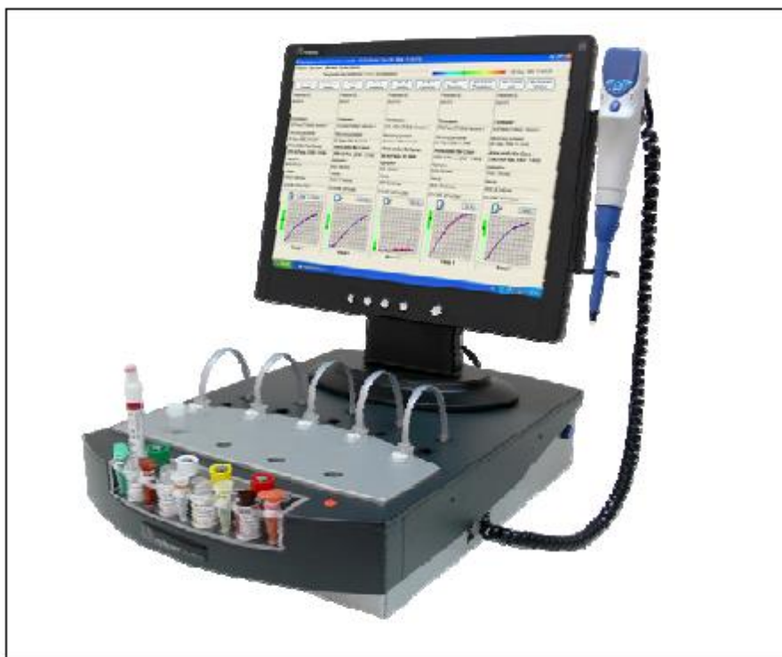
Abbildung 7: Multiplate®-Messgerät mit Monitor, elektronischer Pipette, verschiedenen Reagenzien und eingelegten Einwegmesszellen. ( www.multiplate.net ).
