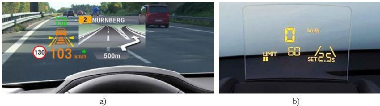
Abbildung 2.6: a) BMW 5er: vollfarbener HUD. b) Peugeot 3008: monochromes HUD.
