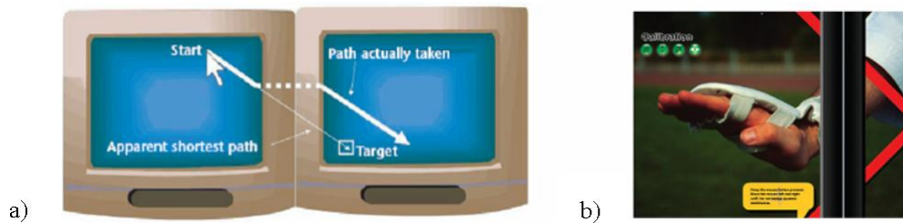
Abbildung 3.5: a) Problem der physikalischen Lücke zwischen zwei Bildschirmen bei Interaktion. b) Shortest path Kalibrierung zwischen den Bildschirmrändern. [89]
