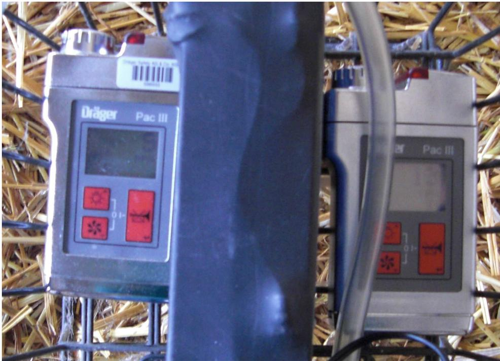
**Abb. 14: Die verwendeten Ammoniakmessgeräte (Dräger Safety AG & Co.KGaA, Lübeck, Deutschland)**
