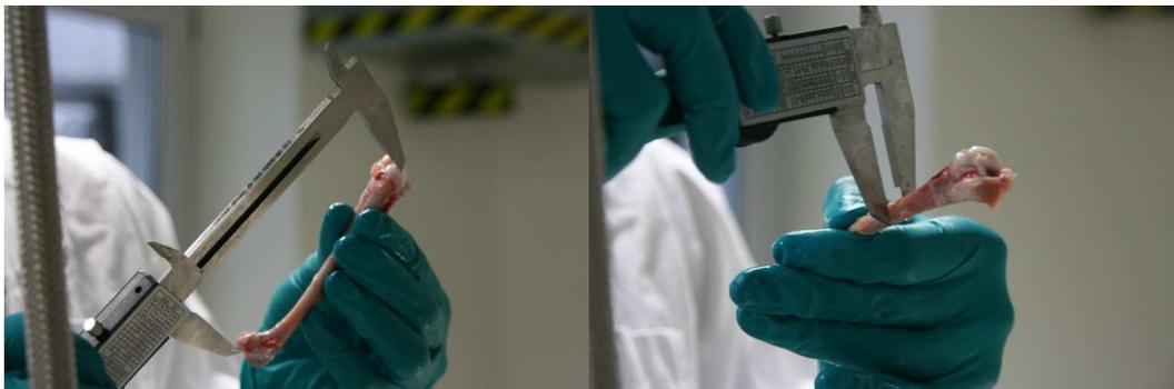
**Abb. 18: Bestimmung der Größenparameter der Knochen mit Hilfe einer digitalen Schieblehre**
