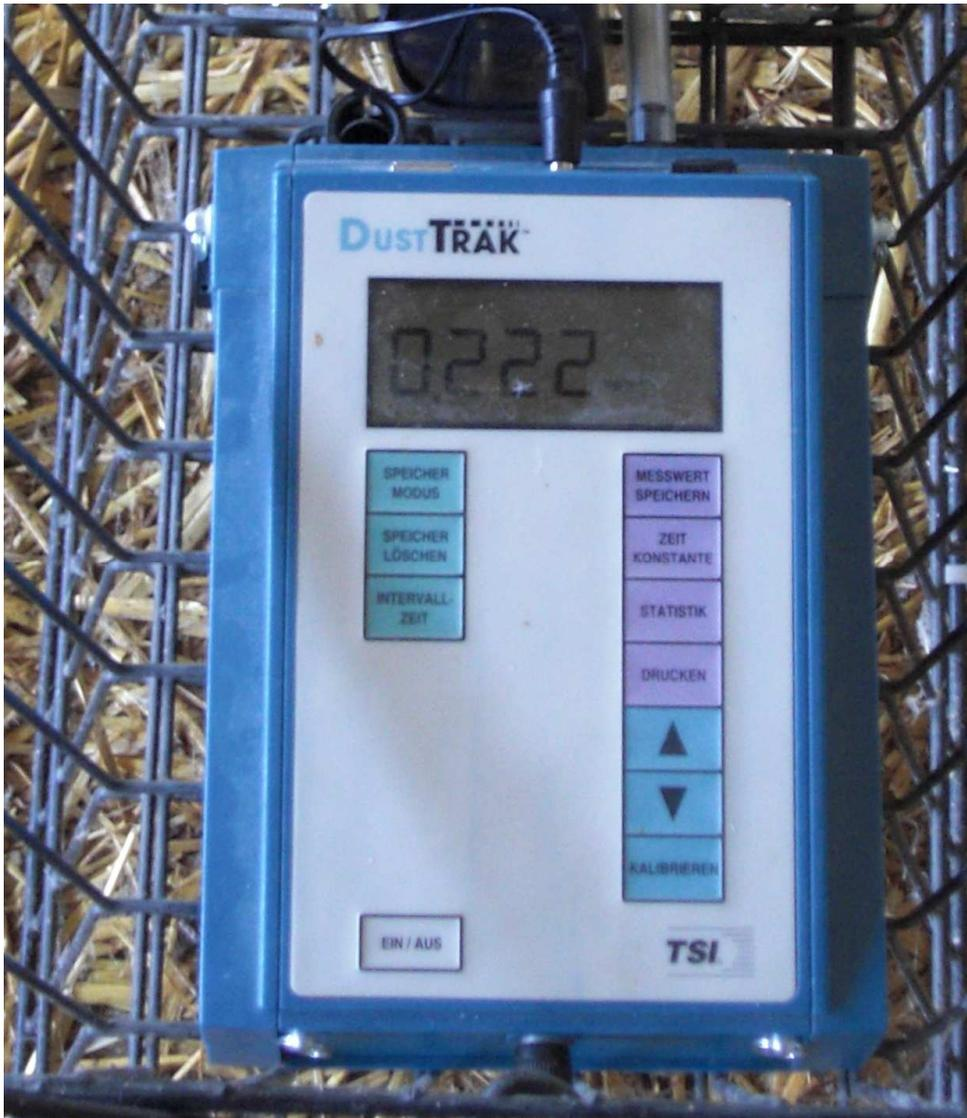
**Abb. 15:** Das verwendete Staubmessgerät (TSI Incorporated, Shoreview, USA)
