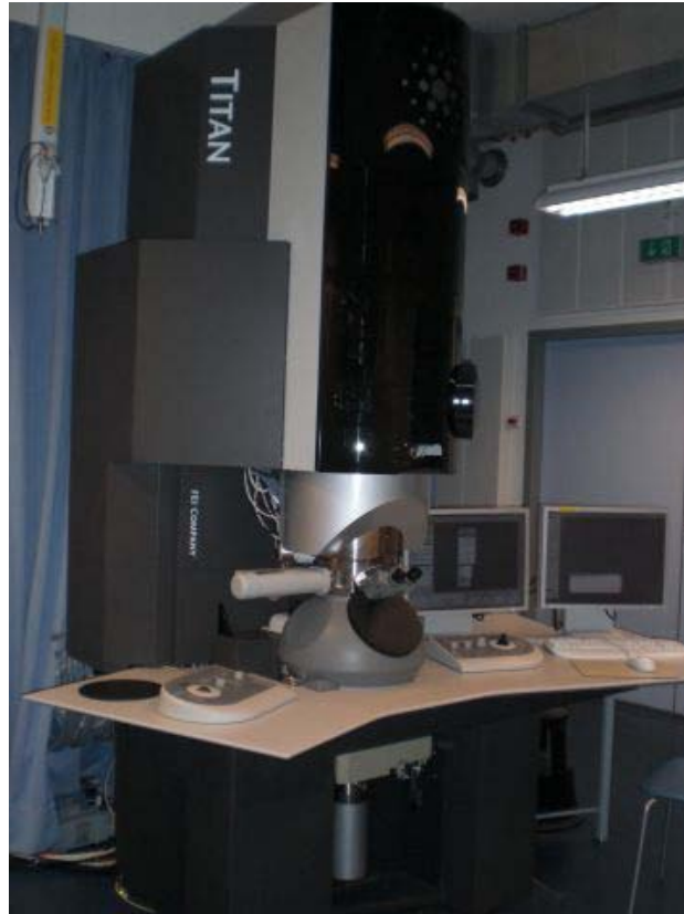
Abbildung 2.10. – Bild des HAADF-Rastertransmissionselektronenmikroskop des Chemie-Departments der LMU München
