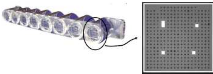
Abb. III-2: Darstellung eines Array-Strips mit den darin enthaltenen DNA-Chips (Alere GmbH, Köln)
