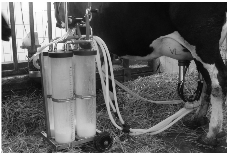
Abbildung 4: Die Vierviertelmelkmaschine mit angesetztem Melkzeug
