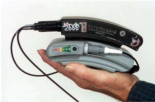
**Abbildung 24:** Lithium-Batterie und Controller
