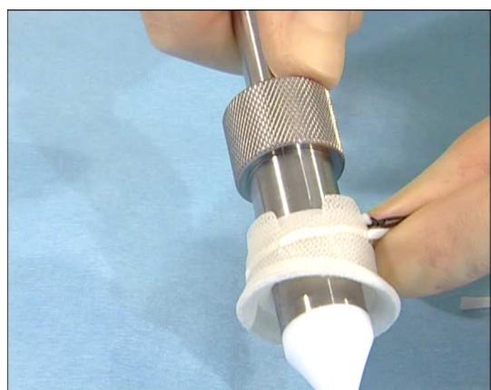
**Abbildung 63:** Schließen und Herausziehen des Ringmessers
