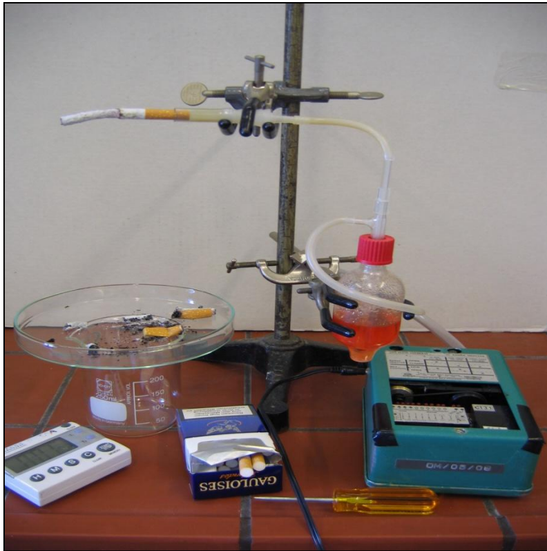
Abbildung 4.5.1: Standardisiertes Verfahren zur Gewinnung von Zigarettenrauchextrakt. Man erkennt die Waschflasche mit 10 mL D-MEM-Lösung pro Zigarette (30 mL insgesamt für 3 Zigaretten in Serie), die mit Hilfe einer Pumpe über ein Schlauchsystem den Zigarettenrauch aufnahm und in Lösung brachte.
