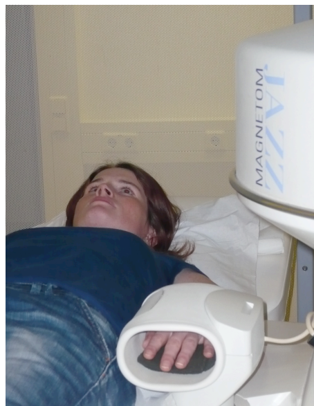
Abbildung 4.3: Darstellung der Extremitätenspule des Niederfeldkernspintomographen
