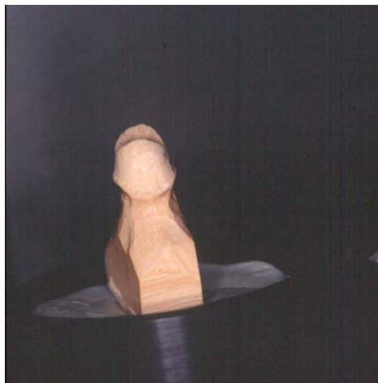
Abbildung 2: Für die Vermessung vorbereiteter und positionierter Gipsstumpf
