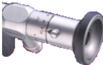
**Abb. II. 1: Filterregler des modifizierten Endoskops mit “WL” – Stellung für die Weißlichtendoskopie, “AF” – Stellung für die Autofluoreszenzuntersuchung, sowie “ALA” – Stellung für die Fluoreszenzuntersuchung nach Einnahme von 5 – ALA.**
