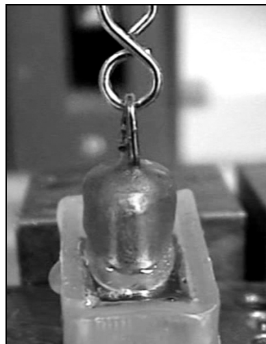
Abbildung 24 AGC® – Sekundärteil vor einem Abzugsversuch, zu erkennen sind die mit Pattern Resin (Fa. GC) fixierte Metallöse und das wachsbegrenzte Reservoir der künstlichen Speichellösung (Ptyalin neutral, Fa. TMP Tüshaus)
