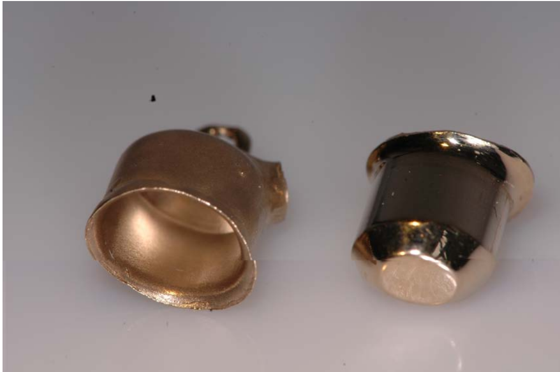
Abbildung 19 Gusstechnisch hergestelltes Primärteil mit 0°-Fräsung und korrespondierendem Außenteleskop
