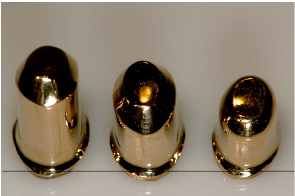
Abbildung 10 Glanzpolierte zylindrische Primärteile aus hochgoldhaltiger Edelmetalllegierung in den drei Stumpflängen ( von rechts 5 mm, 7 mm und 9 mm)
