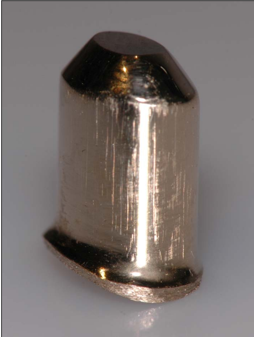
Abbildung 3 Zylindrisches Primärteil mit gut sichtbaren oberflächlichen Riefen nach erfolgten Abzugsversuchen
