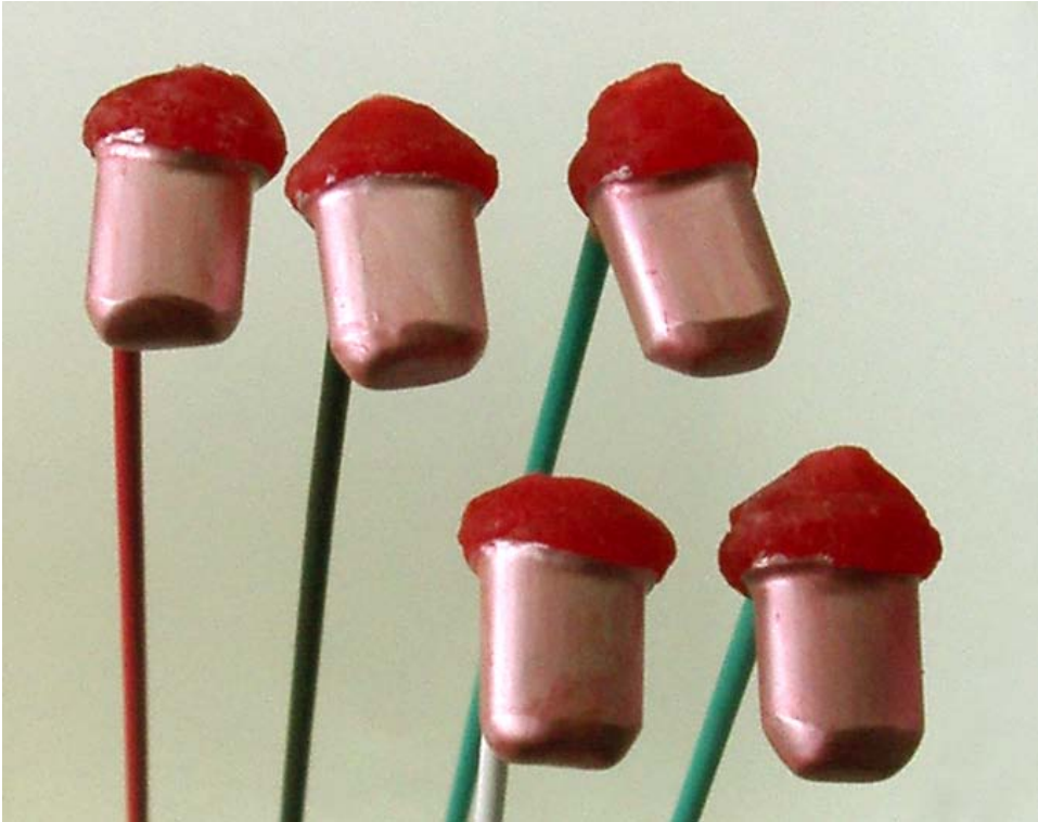
Abbildung 12 Leitsilberlackierte Innenteleskope, befestigt an kunststoffummantelten Kupferdrahtkathoden
