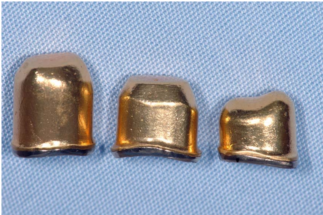
Abbildung 15 Galvanotechnisch hergestellte Außenteile auf ihren dazugehörigen parallelwandigen Primärteilen mit den Stumpflängen 9 mm, 7 mm und 5 mm
