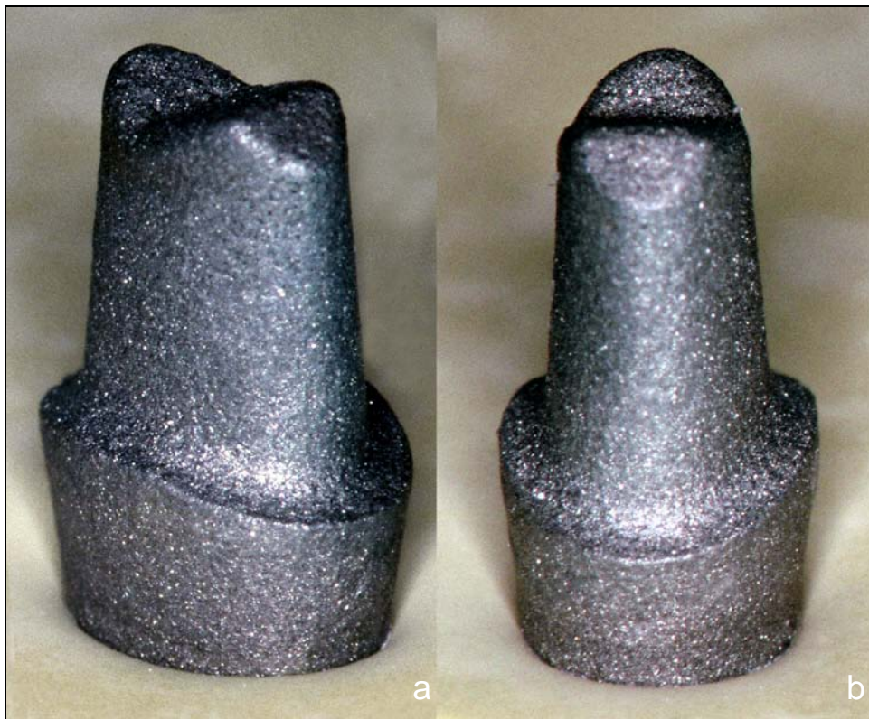
Abbildung 9 a, b: Nahaufnahme der in Gips gefassten Stumpfduplikate
