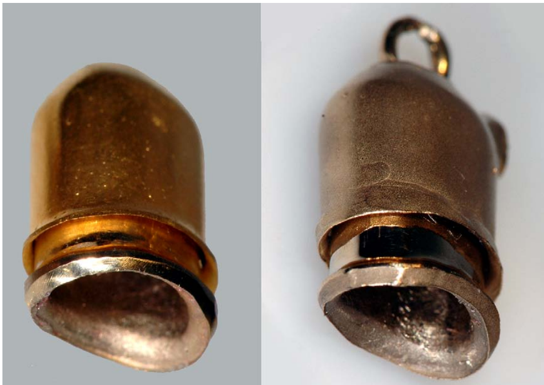
Abbildung 20 Galvanoteleskop und Gussteleskop gleiten auf ihre Primärteile
