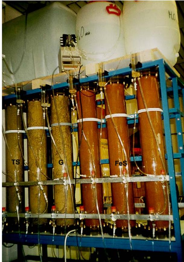
Abb. 23: Säulenaufbau mit den Aquifersedimenten Quartärer Kies (G), Tertiärer Sand (TS) und Dogger-Sand (FeS).
