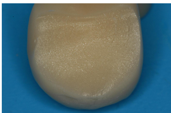
Abb. 46: Bruchfläche der VITA CAD-Temp Kompositblöcke
