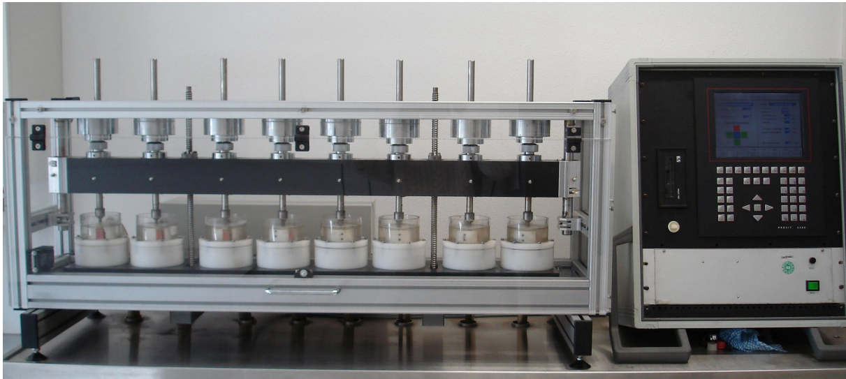
Abb. 43: Proben im Kausimulator Willytec Munich
