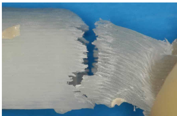
Abb. 47 a+b+c: Fraktur des KaVo C-Temp Brückengerüsts
