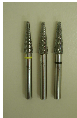
Abb. 10: Zur Feinausarbeitung eingesetztes Fräsen-Set
