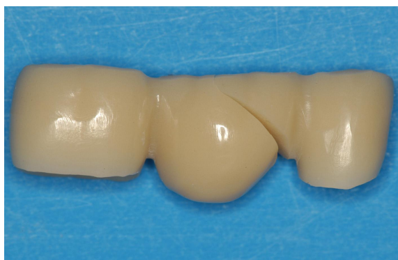
Abb. 45 a+b: Frakturverlauf der VITA CAD-Temp Kompositblöcke
