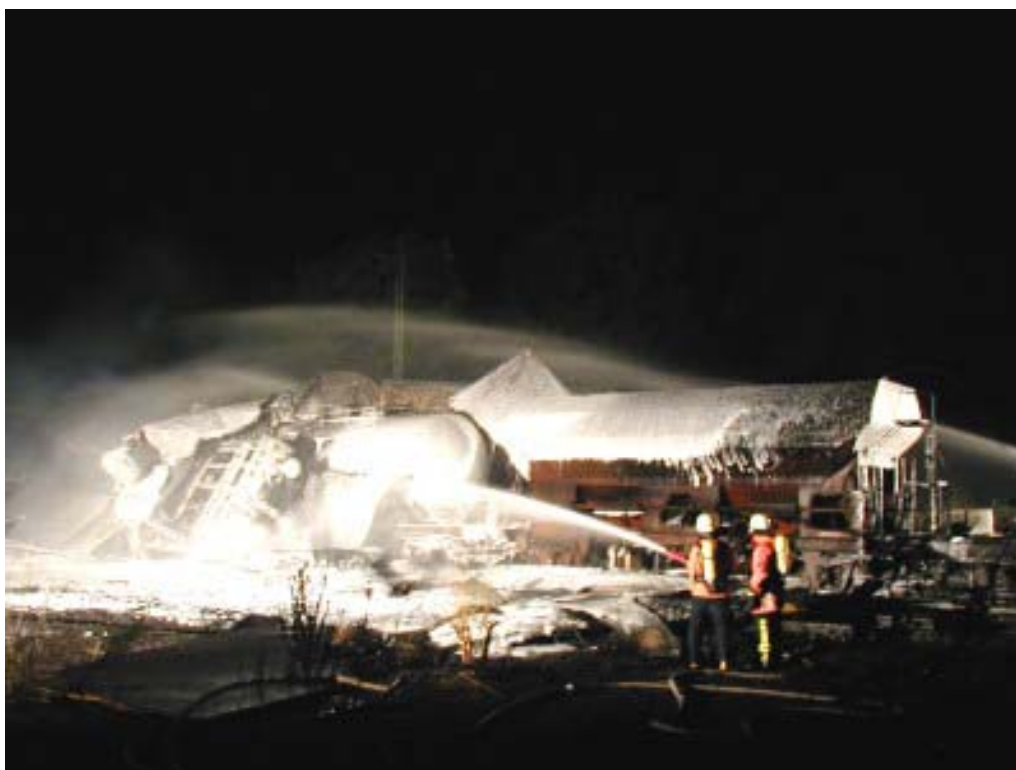
Abbildung 2: Verhinderung des Ausgasens durch den Schaumteppich
