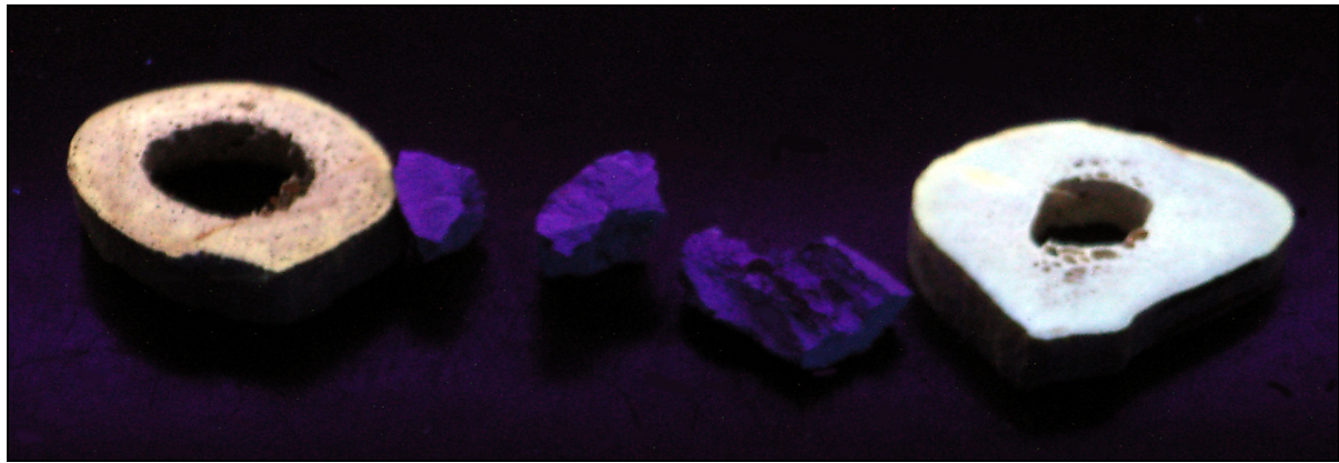
Abb. IV.25: von rechts nach links: Negativkontrolle mit braun/gelber Fluoreszenz, K91: kremierter Knochen mit violetter Fluoreszenz, Positivkontrolle mit Ausprägung der für rezente Knochen typischen hellblauen Fluoreszenz
