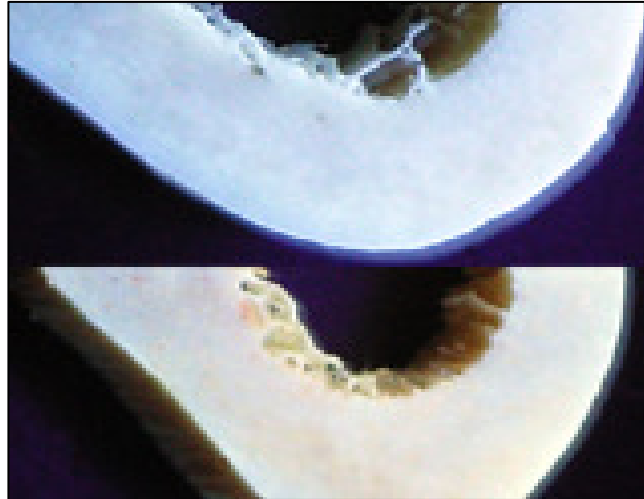
Abb. IV.23: Probe TE II 19, vor (oben) und nach der in vitro Degradation (unten)
