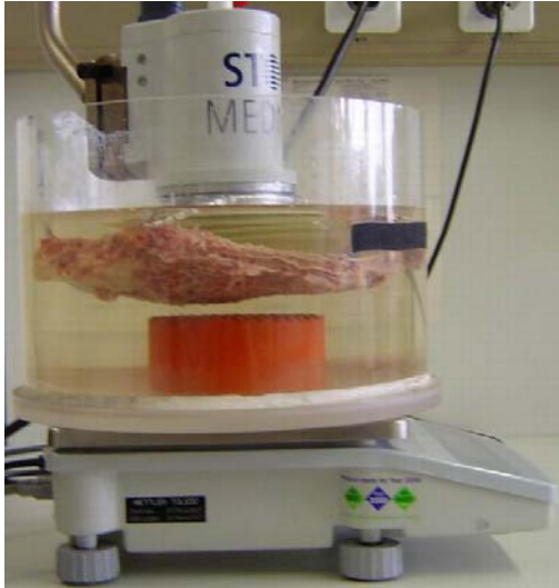
Abb. 17: Messung der Absorption mit der Schallwaage
