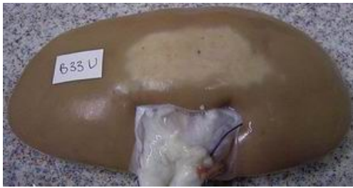
Abb. 51: Nebeneffekt durch Erwärmung am Absorber
