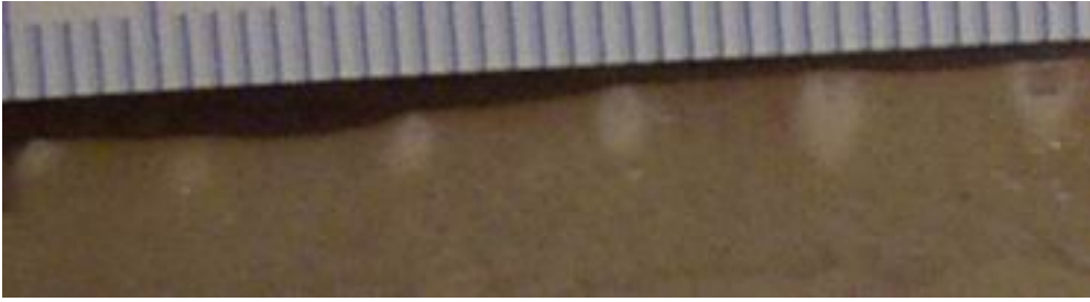
Abb. 63: Läsionsgröße und -lokalisierung bei separater Verwendung eines Schallkopfes (88 W el , 8 s)
