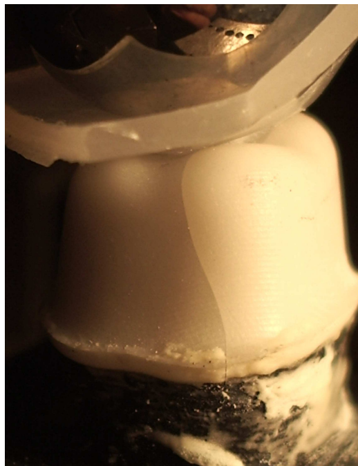
Abb. 25: Gebrochene Probe in der Prüfmaschine
