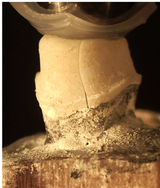
Abb. 27: Gebrochene Probe in der Prüfmaschine
