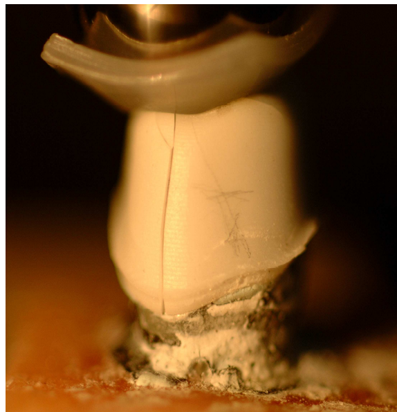
Abb. 23: Gebrochene Probe in der Prüfmaschine
