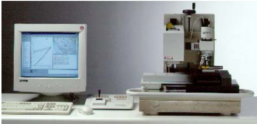
Abb. 4.3.-1 Universalhärtemessgerät (Fischerscope H100C, Fischer Sindelfingen, Deutschland)
