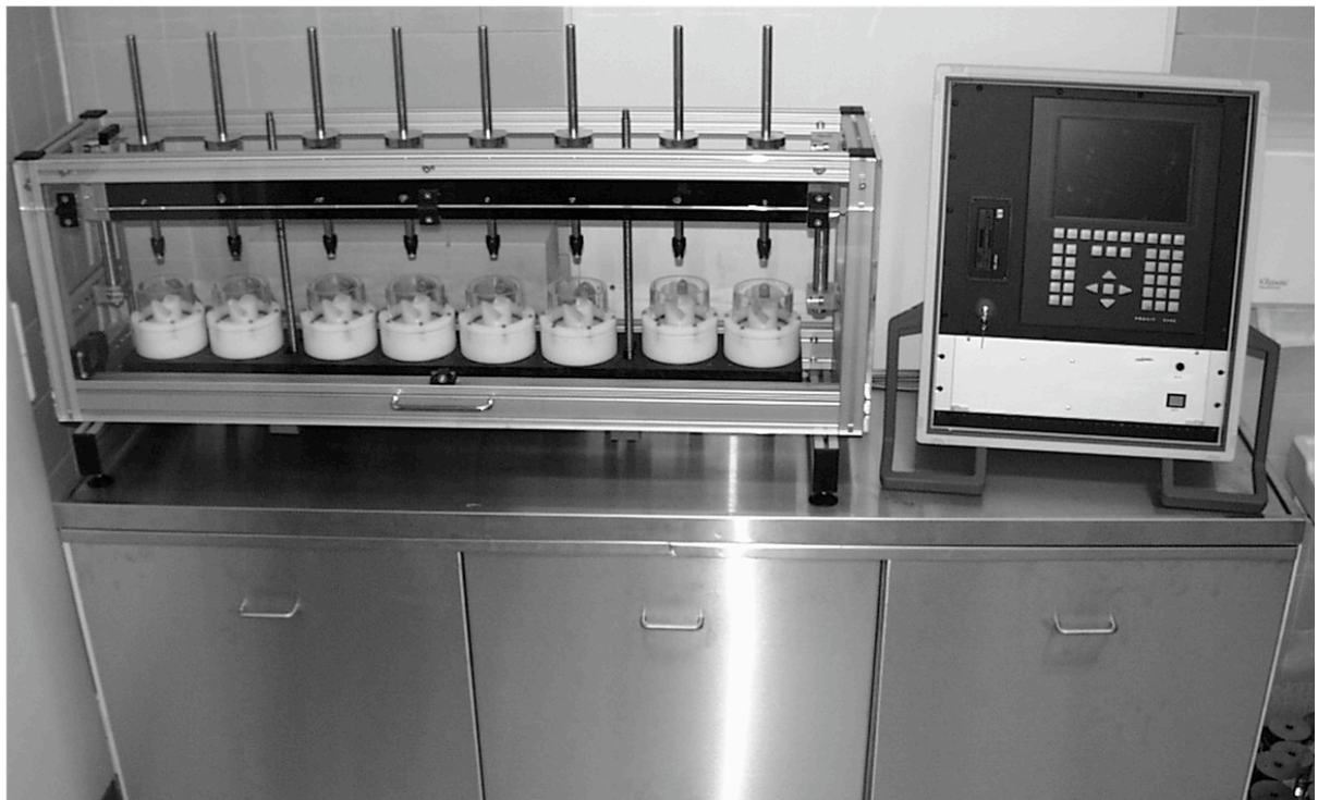
Abb. 3: Münchner Kausimulator, welcher im Rahmen der Studie verwendet wurde
