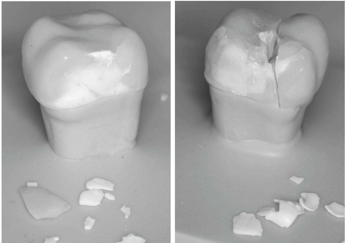
Abb. 10: Kronen mit experimenteller Ivoclar ® -Verblendmasse, links nach Absplitterung der Verblendkeramik (Ivoclar Nr. 12, kein HS) und rechts nach Gerüstfraktur (Ivoclar Nr. 4, HS 180°C)
