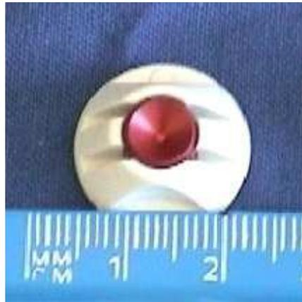
(Schrauben-)marker für die Landmarkendefinition mit zentraler Vertiefung zur besseren Ansteuerung durch die Instrumentenspitze
