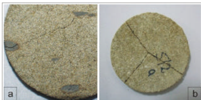
Abb. 8.47 (a-b): Bohrkernscheiben nach der Bruchbelastung. Bild a zeigt ein Rissmuster in einer Scheibe aus Schleerither Sandstein. Die Brüche sind eher ausnahmsweise intensiv mit den Tonlinsen vergesellschaftet. Ansonsten ähneln sie denen in der nebenstehenden Abbildung (b). In Bild b ist das typische, mercedessternförmige Rissmuster in einer Bohrkernscheibe der Varietät II des Regensburger Grünsandsteins zu erkennen.
