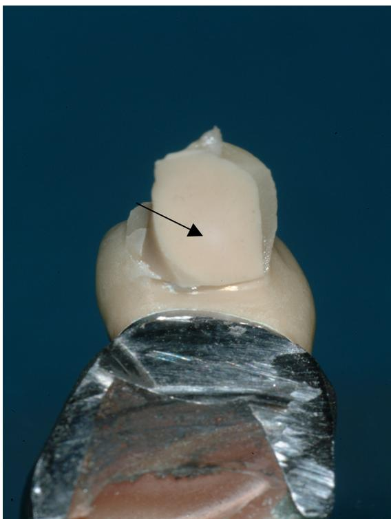
*Abb.44: Brücke 38, Ansicht von lingual, Beispiel eines Infiltrationsdefizites in der Gerüstkeramik des Brückengliedes (Pfeil).*
