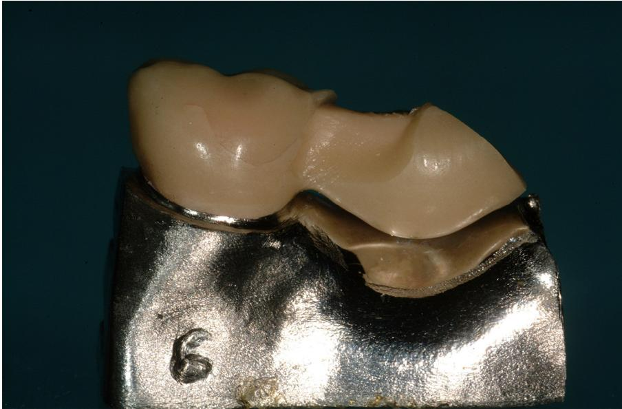
*Abb. 24: Brücke 6, Frontalansicht, klassisches Frakturmuster einer starr gelagerten Brücke auf dem Metallmodell, Bruchverlauf durch die Zentralfissur des Brückengliedes mit diagonaler Durchtrennung des Gerüsts in Richtung der Separation distal des Prämolaren. Distobukkal am Brückenglied kann man eine typische Adhäsionsfraktur zwischen Gerüst- und Verblendkeramik erkennen.*
