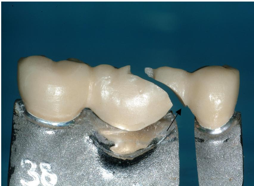
*Abb.43: Brücke 38, Frontalansicht, Die Aufnahme zeigt den Bruchverlauf durch die basale Separation der In-Ceram-Brücke (Pfeil).*
