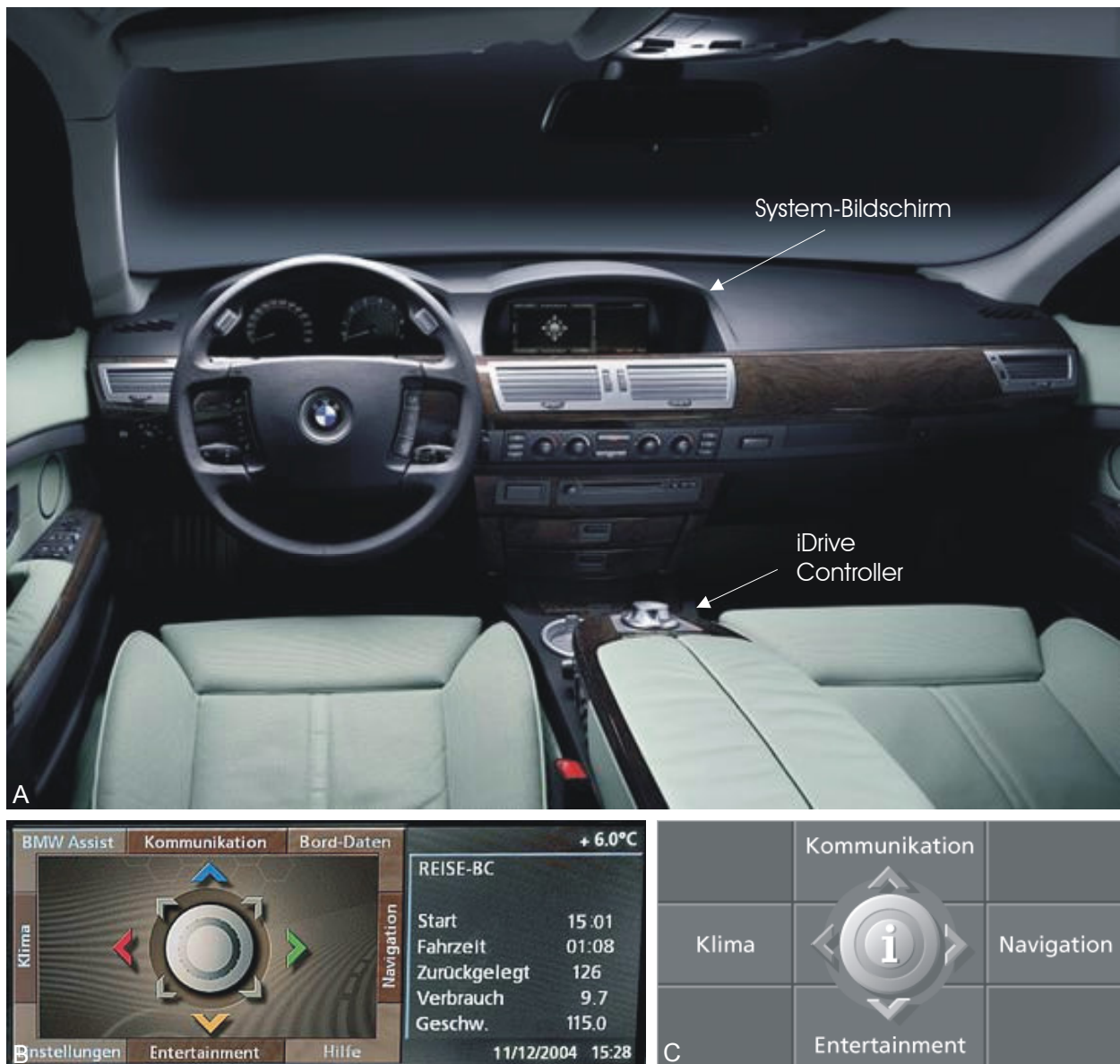
Abbildung 3. Der iDrive von BMW. A) Anordnung des Displays und des Controllers des iDrive Systems im Fahrzeug (gezeigt am iDrive der 7er-Reihe), B) Benutzeroberfläche des Hauptmenüs des iDrives der 7er (Quelle: 7-forum.com) und C) der 5er Reihe (A und C mit freundlicher Genehmigung von BMW AG © Copyright BMW AG, München, Deutschland)
