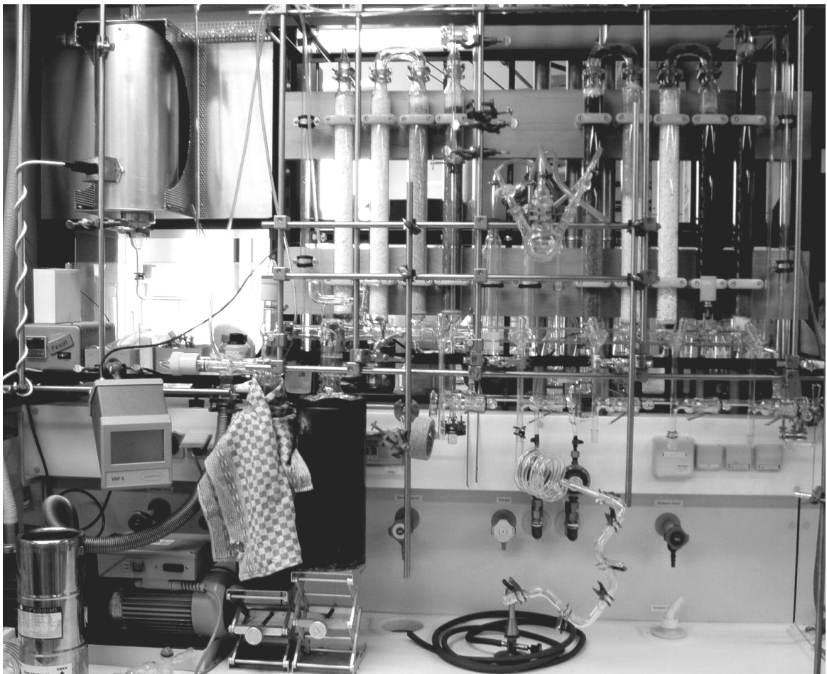
Abbildung 3-2: Vollglasschutzgasanlage mit Vakuumstrang und Gasreinigungsapparatur an der Laborbank.
