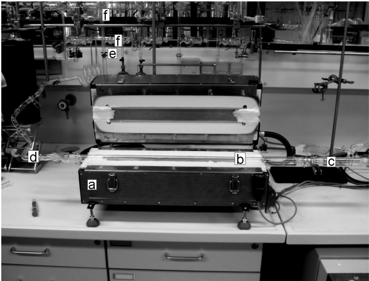
Abbildung 3-9: Apparatur zum thermischen Abbau von luft- und feuchtigkeitsempfindlichen Verbindungen. Umsetzungen sind unter Gasatmosphäre und unter Vakuum möglich.
