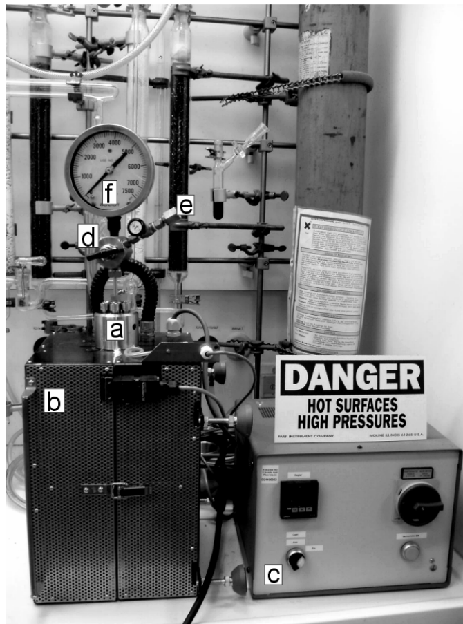
Abbildung 3-10: Autoklav mit Umgebungsheizung für Reaktionen in überkritischem \text{CO}_2 .
