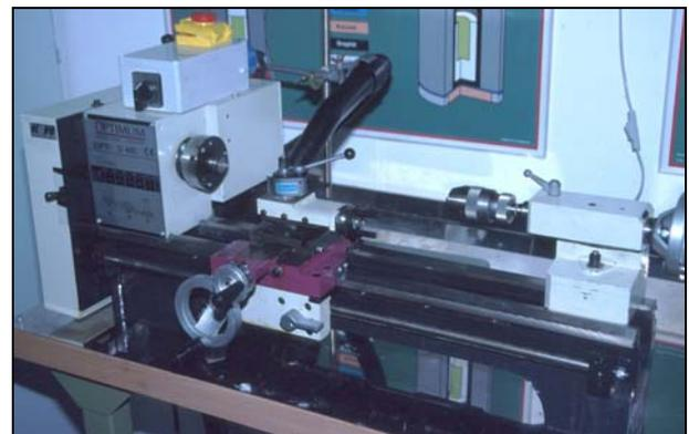
**Abbildung 2.25** Drehbank zur Fertigung der Assemblyteile.<sup>[40]</sup>
