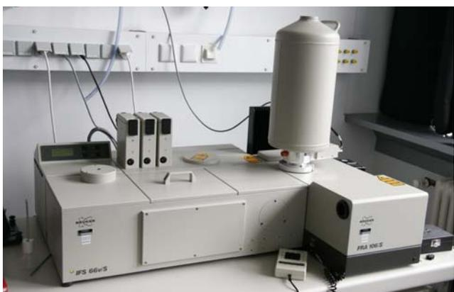
**Abbildung 2.60** Bruker IFS 66v/S FTIR Spektrometer.
