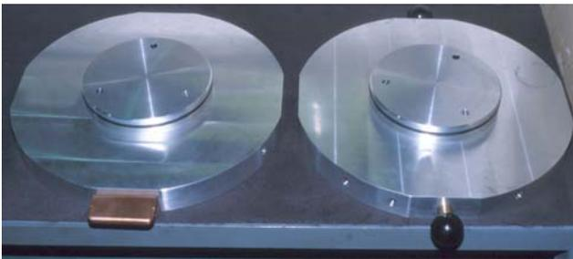
**Abbildung 2.5** Untere (links) und obere (rechts) Druckübertragungsplatte.<sup>[40]</sup>
