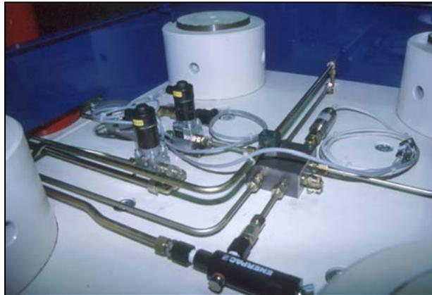
**Abbildung 2.11** Hydraulikventile und Ölleitungen auf der Oberseite der 1000 t-Pressen.<sup>[40]</sup>
