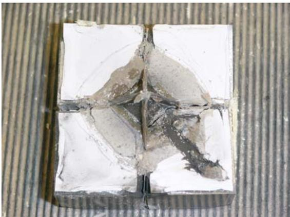
**Abbildung 2.53** Eine zerflossene Molybdänkontaktplatte hat eine der Dichtungen durchtrennt und einen Blowout verursacht.
