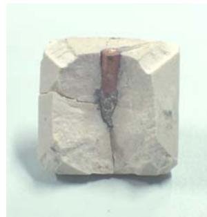
**Abbildung 2.39** Photographie des nach der Kalibrierung aufgebrochenen Oktaeders.<sup>[40]</sup>
