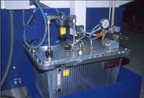
**Abbildung 2.8** Haupt-Hydraulikaggregat mit Ölreservoir zum schnellen Vortrieb des Stempels.<sup>[40]</sup>
