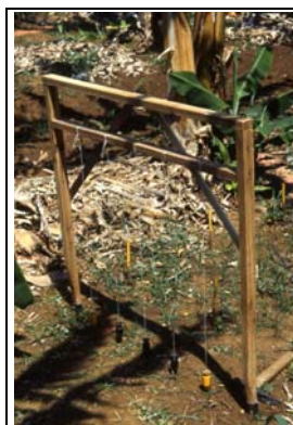
Foto 30 (rechts): Mitte der 90er Jahre konnte der Autor unter anderem mit diesem Erosionsmeßrahmen in einem landwirtschaftlich intensiv-genutzten Gebiet im Süden der Provinz Ciudad de La Habana über einen Zeitraum von annähernd zwei Jahren quantitative Abtragsmessungen durchführen (Ammerl 04/1996)
