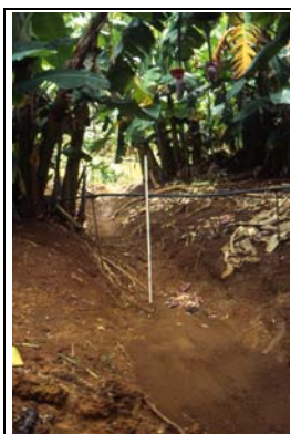
Foto 30 (rechts): Mitte der 90er Jahre konnte der Autor unter anderem mit diesem Erosionsmeßrahmen in einem landwirtschaftlich intensiv-genutzten Gebiet im Süden der Provinz Ciudad de La Habana über einen Zeitraum von annähernd zwei Jahren quantitative Abtragsmessungen durchführen (Ammerl 04/1996)
