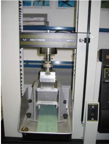
**Abbildung 9: Gerät zur Fleischfestigkeitsmessung**
