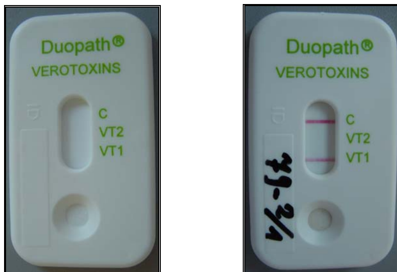
Abb. 15: Ergebnis Duopath® Verotoxin GLISA (Merck) links: Testkit ohne Probe rechts: Testkit mit Probe nach 20 min. Inkubation
