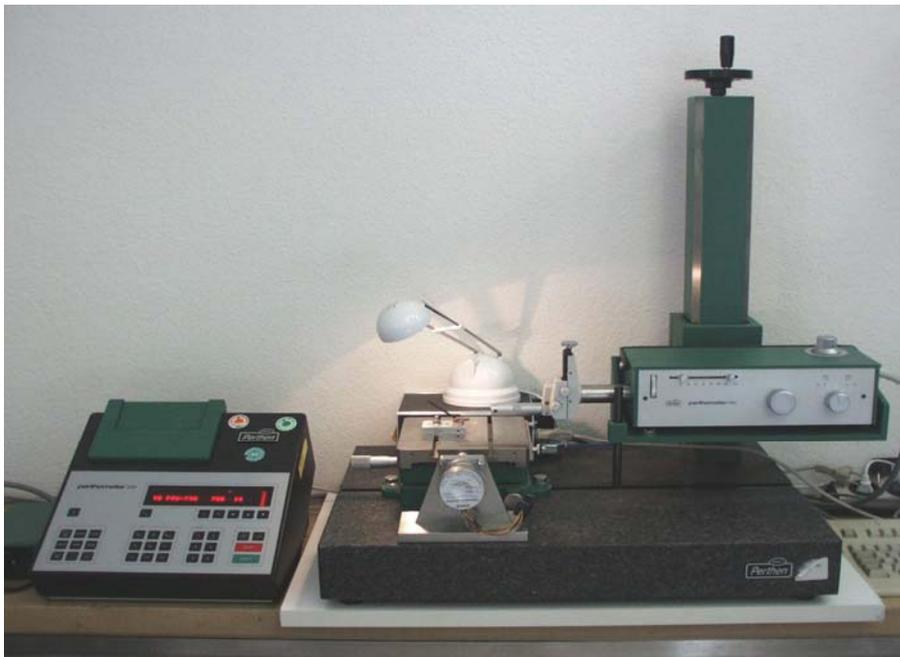
Abbildung 8: Oberflächenmessgerät
