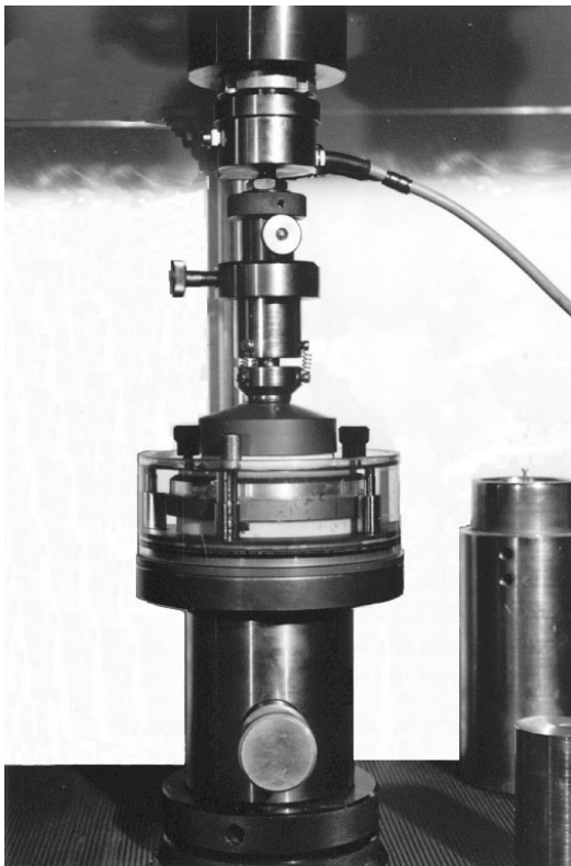
Abb. 89: Belastungseinheit der Universalprüfmaschine.
