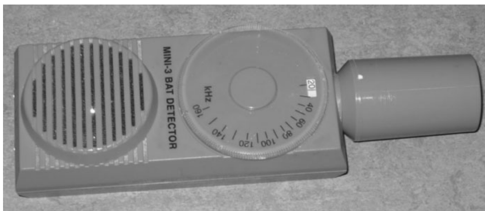
Abbildung 6: verwendeter Batdetector: mini 3 batdetector, Firma Ultrasound Advice, London, UK
