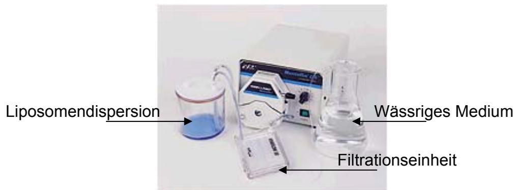
Abbildung 5: Versuchsaufbau der Tangentialfluss-Filtration
