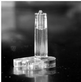
Abbildung 3: Probenkammer des pulsierenden Blasensurfactometers. Kapazität: 30  $\mu\text{l}$ .
