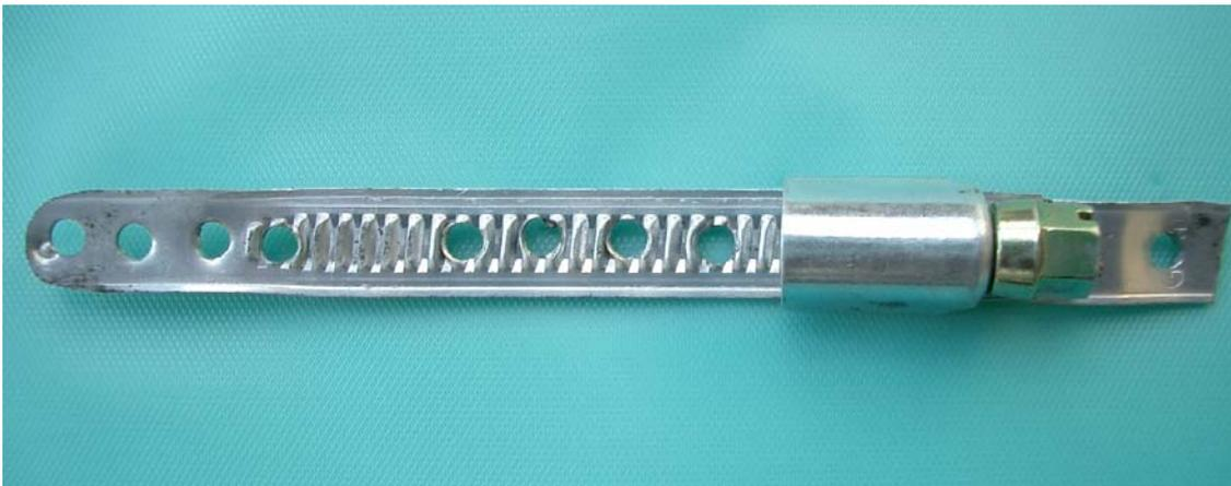
Abbildung 3: Fertige Schneckengewinde-Lochplatte im Endzustand
