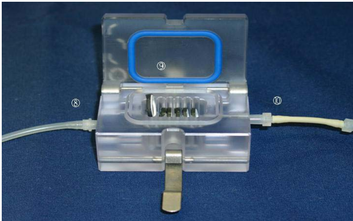
Abb.6: Minuth-Kammer mit Zufluss ⑧, Geweberingen ⑨ und Abfluss ⑩
