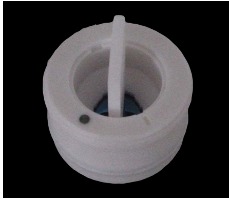
Abb. 5.4-4 Meßkammer mit eingesetzter Trennwand aus Teflon. Mit Hilfe dieser Trennwand lassen sich die beiden Halbräume der Kammer mit unterschiedlichen Zellen besiedeln.
