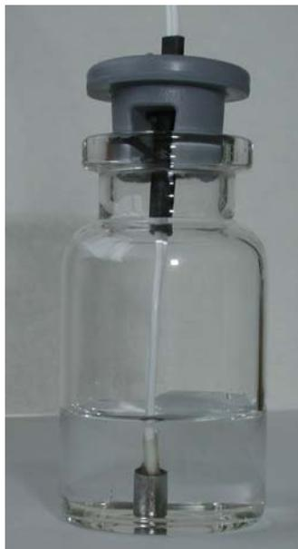
**Abbildung III-26 Vial mit einem kleinen Temperaturfühler in idealer Messposition**
