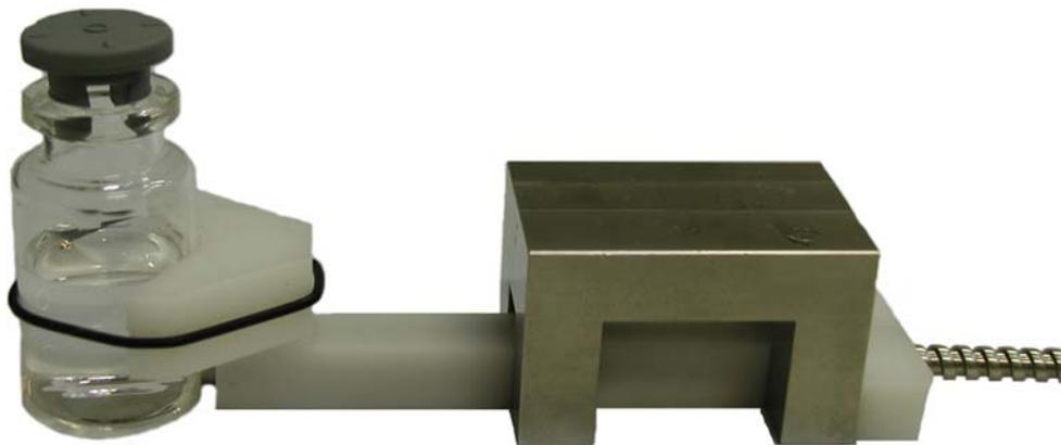
**Abbildung II-5 NIR Messsonde mit Probenhalterung bei der Messung eines 10R Vials**
