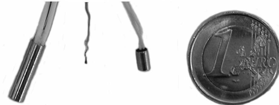
**Abbildung I-21** Verschiedene Temperaturfühler im direkten Größenvergleich.
