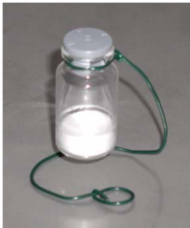
**Abbildung III-12 Foto eines Vials mit speziell gebogener Drahtschleife angehoben**
