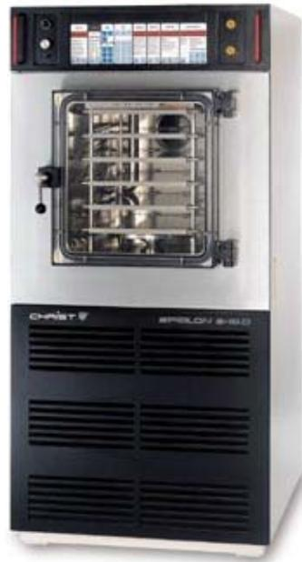
Abbildung I-17 Foto eines Pilotgefrieretrockners, Eiskondensatorkapazität 10-12Kg<sup>82</sup>
