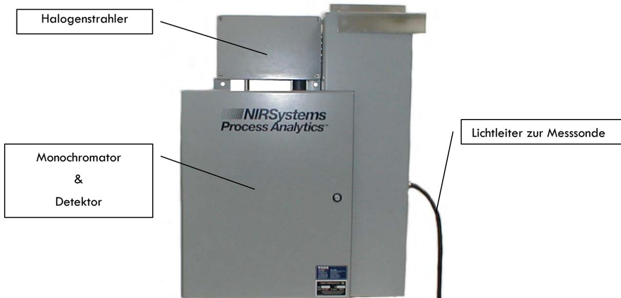
**Abbildung II-4 Nah Infrarot Spektrometer 6500 Online der Fa. Foss**
