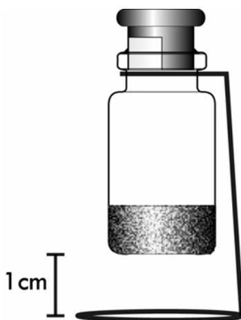
**Abbildung III-11** ‚kontaktlose‘ Gefriertrocknung durch Aufhängen der Vials an einer Drahtschleife
