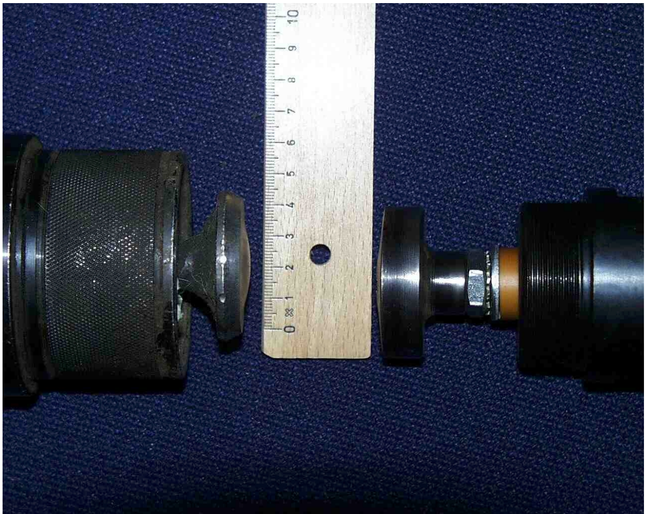
Abb. 11: Links im Bild der Schlagkopf des "Knockers" der Firma Cash und rechts der der Firma Schermer
