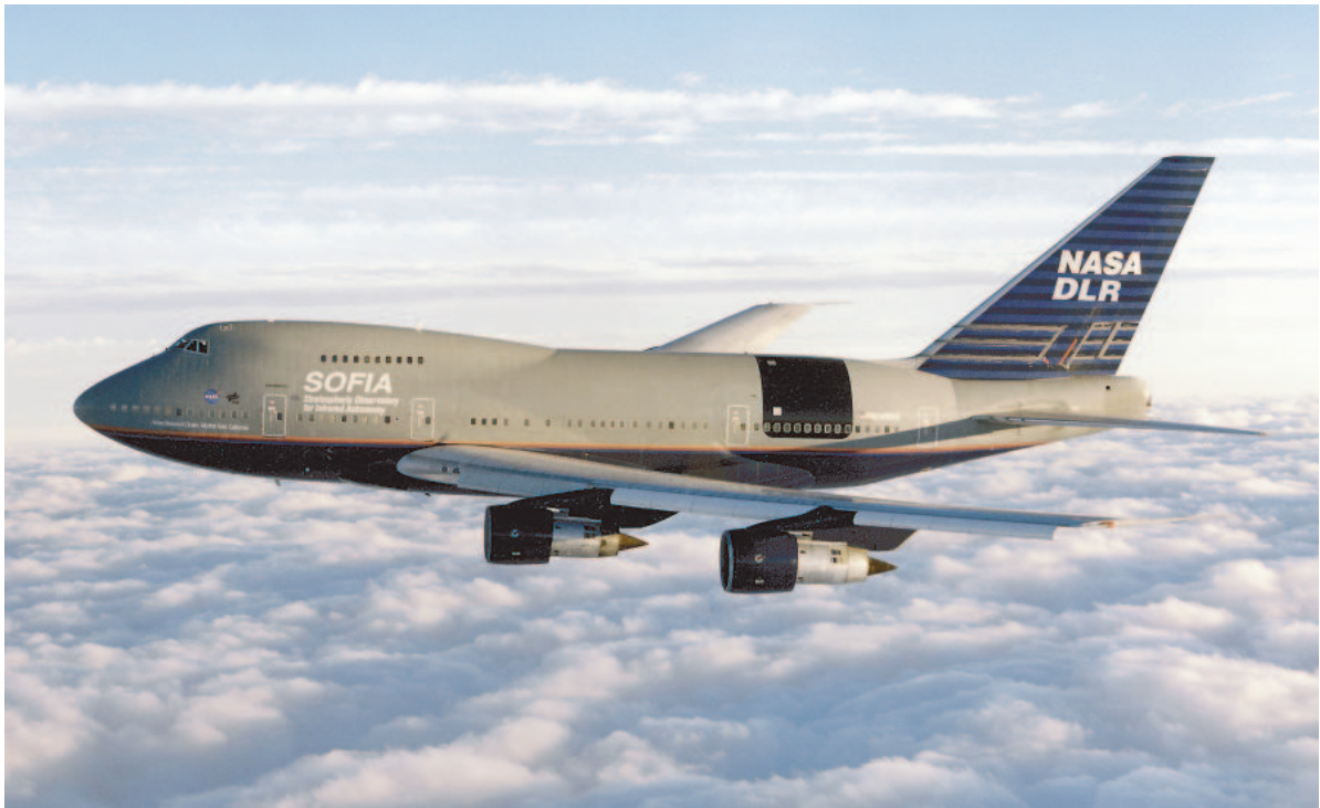
Abbildung 1.2: Das SOFIA Flugzeug bei einem Testflug im Jahr 1997 vor der Modifikation. Diejenige Stelle am Flugzeugrumpf an der sich später die Beobachtungsöffnung befinden wird ist hier schwarz bemalt.
