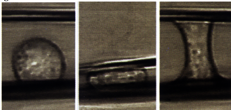
Abb. 3.9: Eine Zelle wird auf ein Glasplättchen gebracht und mit einer Mikronadel aus Glas angedrückt. Nach einer gewissen Zeit ist die Zelle an beiden Glaskörpern fest adhärenzte und kann gedehnt werden (aus [70]).
