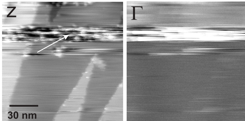
Abbildung 6.4: Die Calcit-Oberfläche nach einem Kontakt mit der Spitze. Auf der linken Seite ist die Topographie ( z ) abgebildet, auf der rechten Seite das damping ( \Gamma ). Die Aufnahme wurde bei einer mittleren Verstimmung von -2.5 Hz gewonnen.
